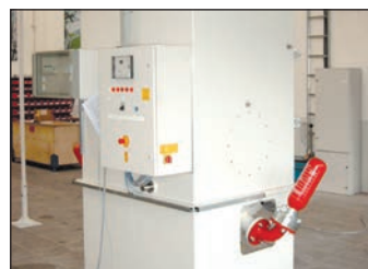
Explosionsunterdrückung durch automatische Löschmitteleinbringung
