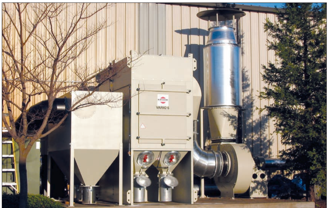
VARIO 6 mit Funkenvorabscheider und Ventilator mit Ausblasschalldämpfer
