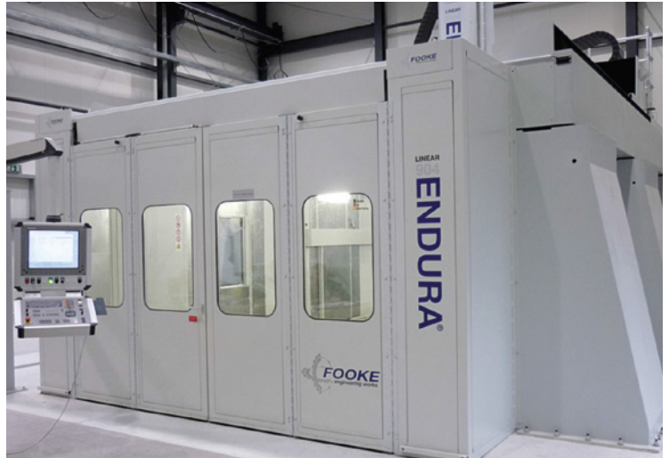
Portalfräsmaschine mit Umhausung
