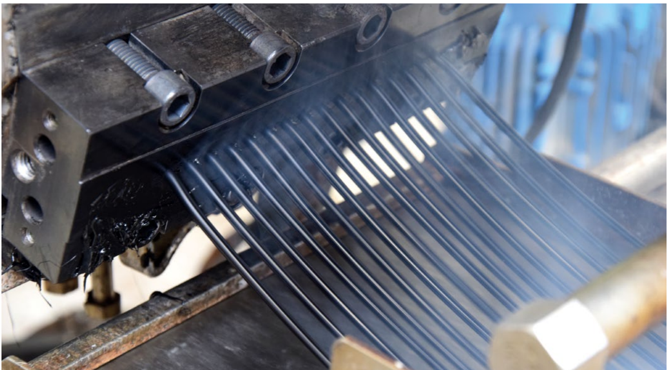
Das zermahlene Ausgangsmaterial wird durch Zugabe von Additiven in einem erneuten Extrusionsprozess zu erstklassigem Recompound verarbeitet, aus dem sich neue Produkte herstellen lassen.
